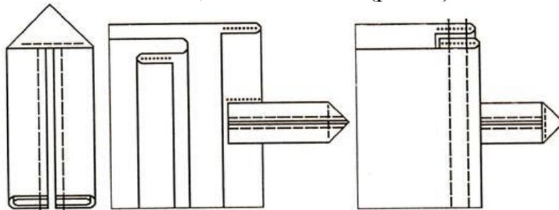
Рис.1 Обработка навесной петли и соединение ее с воротником
